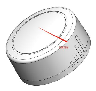
注: 天线方向指 PCB 板载天线信号强度最强的方向
